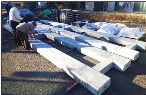
▲新たに導入したラダーマクラギ
