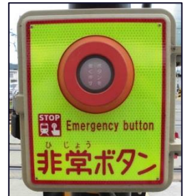
▲踏切支障放置装置
